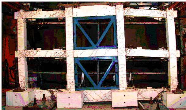
(a) 試験体No.1 (基礎回転破壊)
