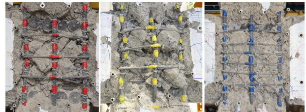
柱主筋 : 8-D16 8-D13 8-D16 横補強筋 : 2-D6,3組 2-D6,3組 2-D4,6組 (a)試験体S1 (b)試験体S2 (c)試験体S3
