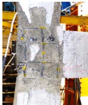
写真 2 試験体 K3 最終破壊状況
